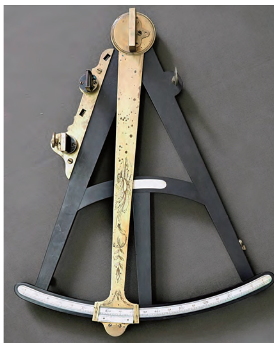
Ryc. 4. Piękny i świetnie zachowany XVIII-wieczny duży oktant hebanowy z grawerowaną alidadą (Muzeum Narodowe w Szczecinie)
