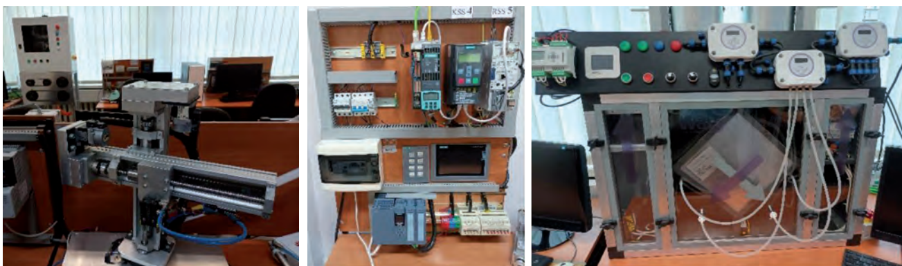
Stanowiska dydaktyczne ze sterownikami PLC
